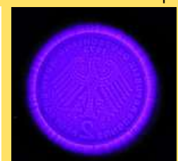
Abb. 19 & 20: 2DM-Münze bei 8 kHz und 15kV in Kontakt- und klassischer Fotografie
