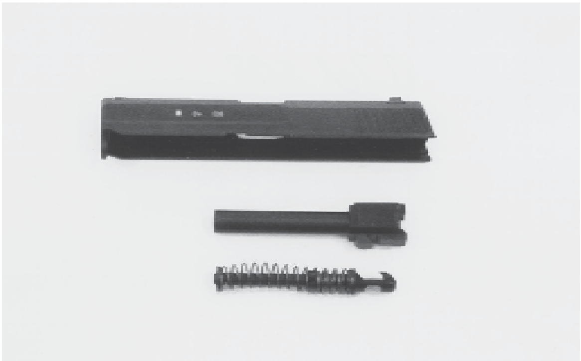
Verschluss und Rohr und Pufferstange, vollständig
