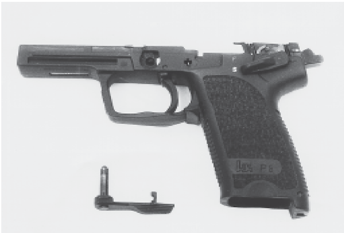
Griffstück (mit Verschlussfanghebel)
