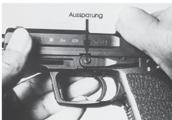
Lage Aussparung/Verschlussfanghebel Verschlussfanghebelachse Zerlegen der Pistole
