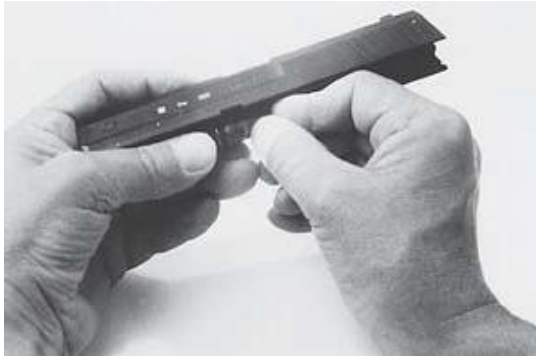
Pufferstange einlegen (vollständig)
