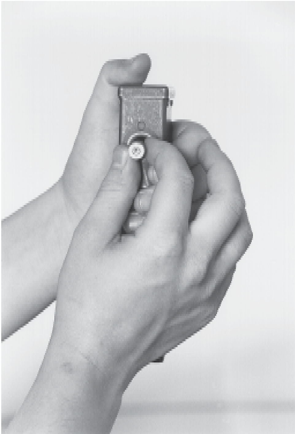
Aufmunitionieren mit Aufmunitionierhilfe
