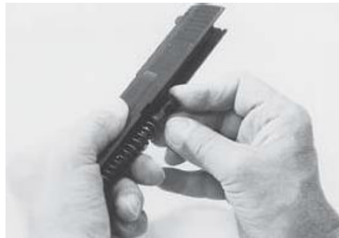
Pufferstange (vollständig) herausnehmen
