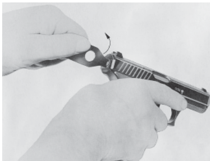
Schlagbolzen einbauen, Buchse nach links drehen
