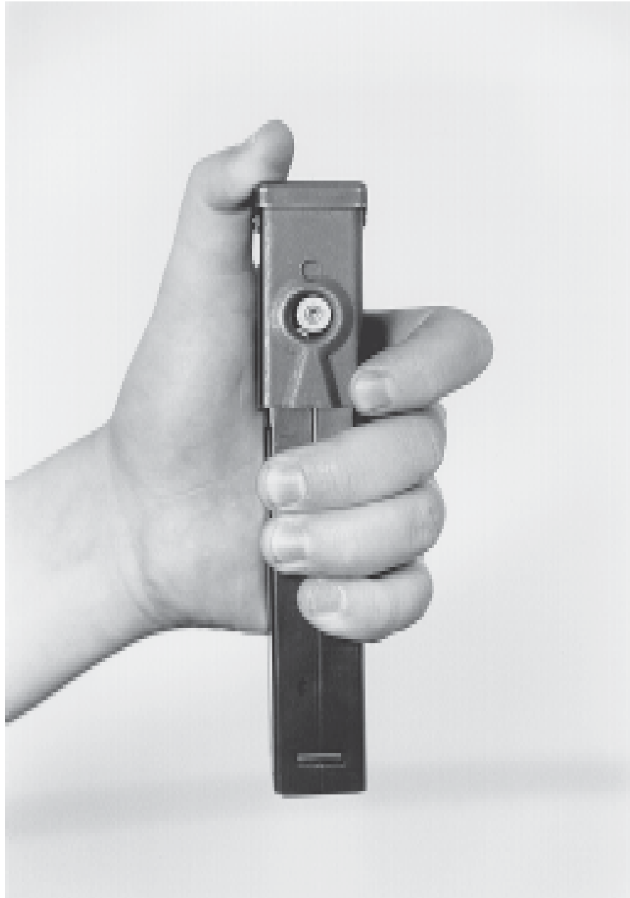
Aufmunitionierhilfe nach unten drücken
