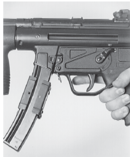
Magazin mit Magazinklammer in Magazinschacht eingeführt
