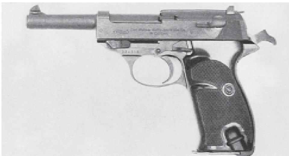
Pistole fertiggeladen, gespannt und entsichert (feuerbereit)
