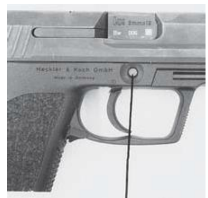
Lage Aussparung/Verschlussfanghebel Verschlussfanghebelachse Zerlegen der Pistole
