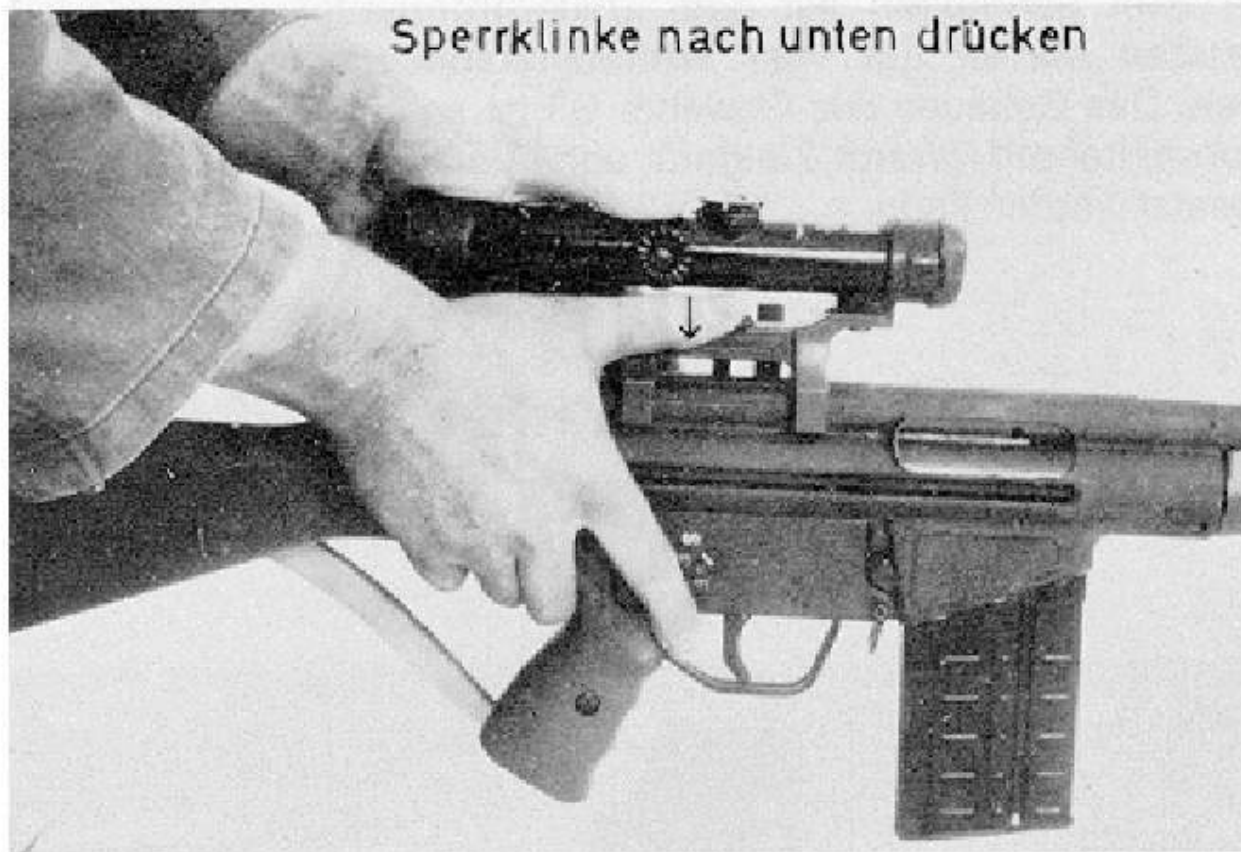
Abnehmen des Zielfernrohrs
