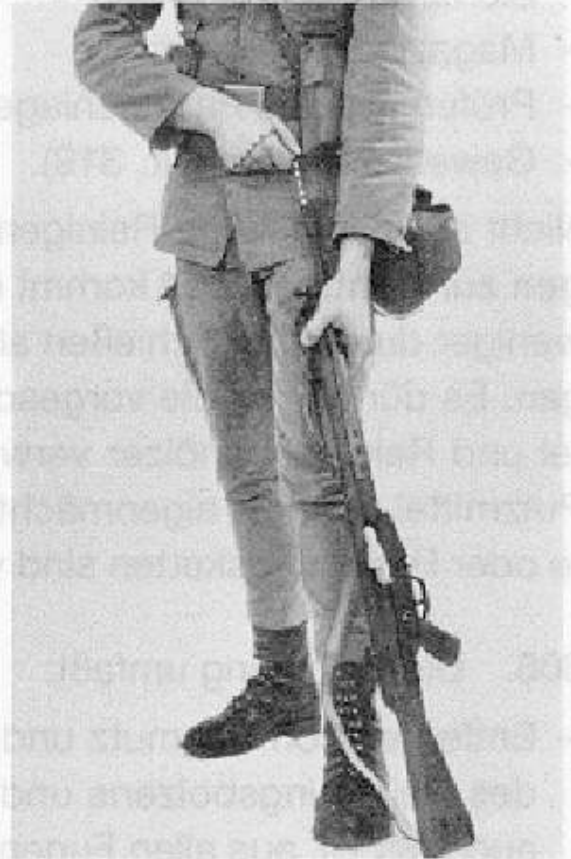
Durchziehen des Rohrs mit Reinigungskette und Docht
