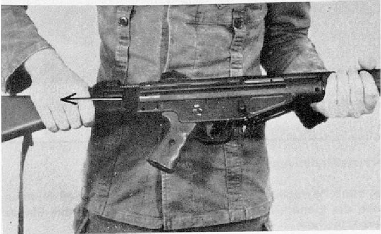
Bodenstück mit Schulterstütze abnehmen
